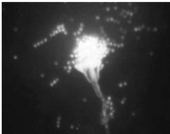
Bild 3 | Penicillium -Sporenträger auf der Reinluftseite eines bei 100 % relativer Luftfeuchte inkubierten Kunstfasersfilters (Präparat gefärbt mit Fluoreszenzfarbstoff).
