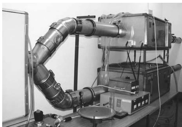
Bild 5 | Schema des verwendeten Klimakanals der Firma DMT mit erster Strömungsstrecke (oben) und zweiter Strömungsstrecke (unten) (Pfeile symbolisieren Strömungsrichtung).
